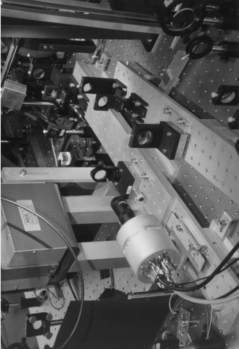
Abbildung 3.5: Blick über das Abbildungssystem in Richtung der magnetischen Falle. Im Vordergrund ist die Kamera zu erkennen. Es sind zwei optische Bänke für verschiedene Vergrößerungsstufen gezeigt. Auf jeder Bank sind zwei Linsen und ein Bauteil für die Phasenkontrastmikroskopie zu erkennen.
